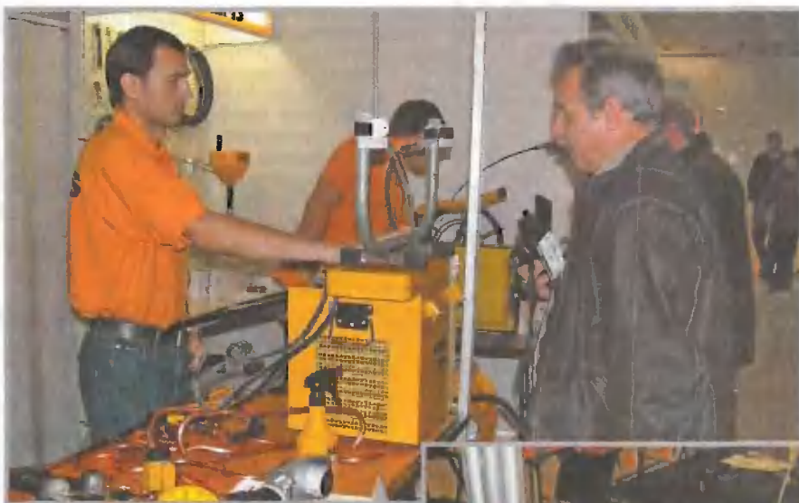
Электрический аппарат для заморозки труб. Позволяет работать на магистрали без слива воды из системы
